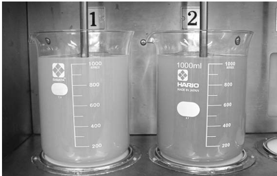
本凝集剤添加直後(攪拌開始時)
