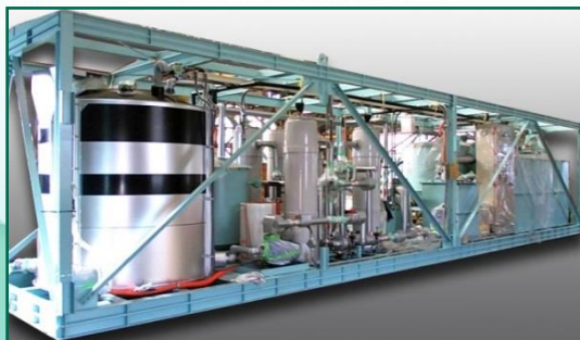
■ 実績例：遺棄化学兵器処理関連工事用水処理装 0.5m 3 /時 中国
