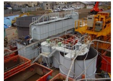
■ 実績例: 土壌浄化に伴う水処理 複合汚染 80m 3 /時 関東圏内
